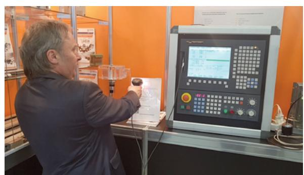
УЧПУ NC-400: с помощью сканера штрих-кода появилась возможность считывать QR-код и вызвать из памяти и запустить управляющую программу, либо внести коррекции инструмента.
