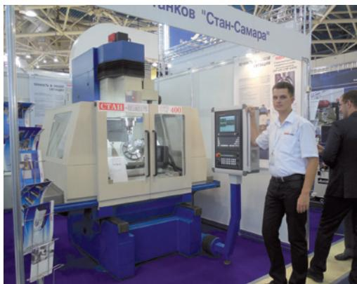
Пятикоординатный сверлильно-фрезерно-расточечный станок особо высокой точности СКР-400, производства станкозавода «Стан-Самара». Комплектация этого оборудования системой ЧПУ NC-310 фирмы «Балт-Систем» позволяет использовать режим управления интерполяцией пятью осями и режим пятиосевого преобразования с 3D-компенсацией инструмента.
