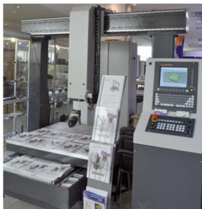
Вертикальный Фрезерный пятиосевой станок с ЧПУ «Балт-Систем» колонного типа - Роутер 1210 Серво производства Завода 1210
